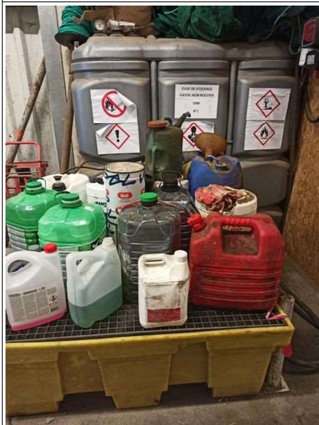
Bidons sur rétention, étiquetage à revoir
